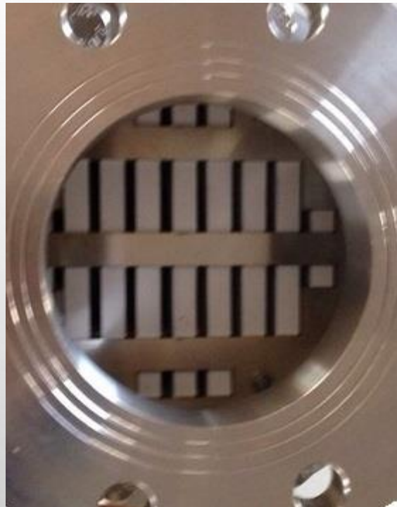
Detalle interno de la salida de gas
