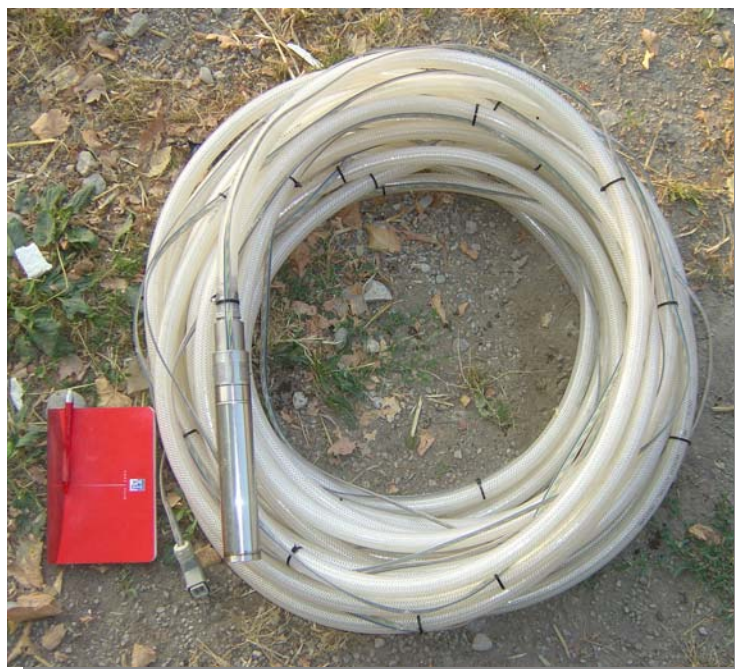
Fotografia 2.3. Bomba submergible per a purga i mostreig de piezòmetres.
