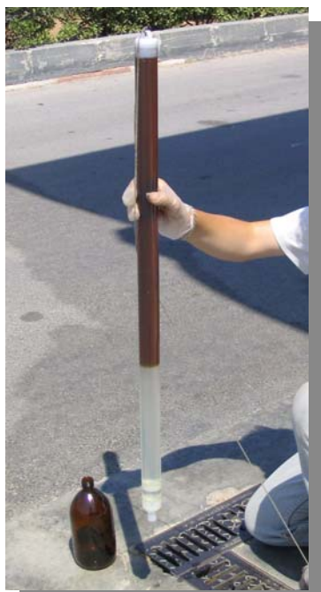
Fotografia 2.2. Mostrejador tipus bailer (d'un sol ús).
