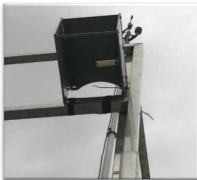
Figura 9. Captador passiu instal·lat a la Unitat Mòbil
