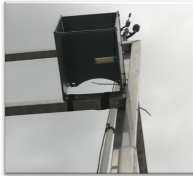
Figura 9. Captador passiu instal·lat a la Unitat Mòbil
