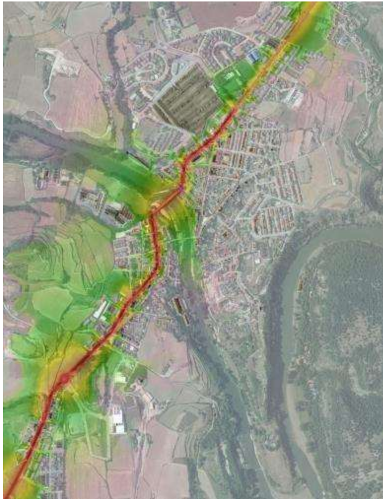
Imatge 10 Simulació de la variant de Manlleu – Impacte C-153. Període Dia. Font: Axioma i Google Earth
