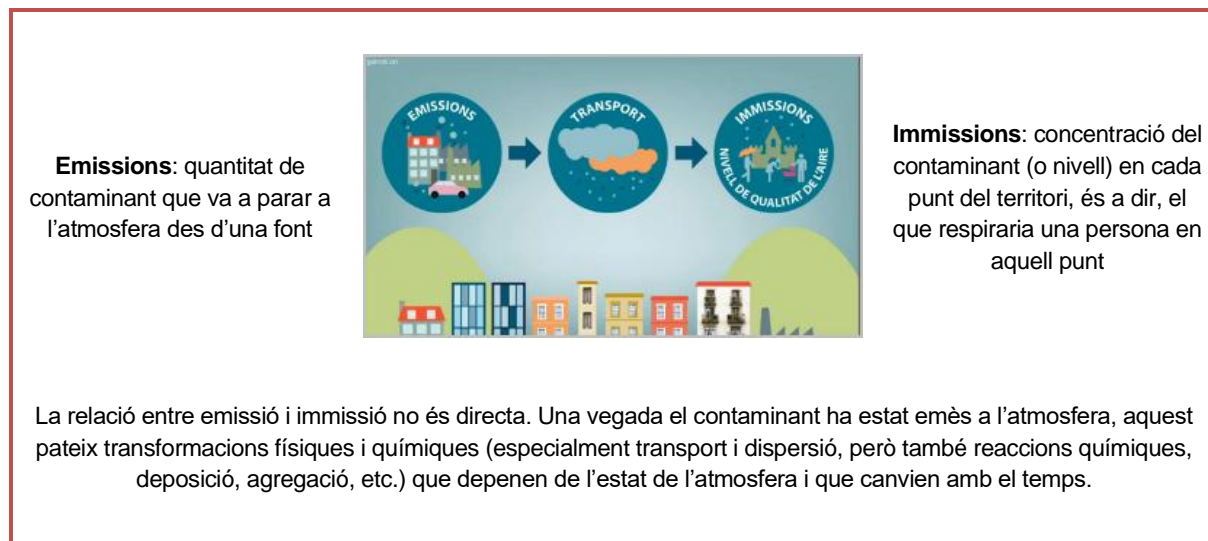
Figura 41. Relació entre les emissions i les immissions d'un contaminant atmosfèric.
